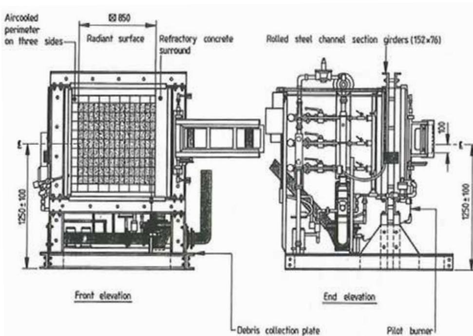
Tale metodo prevede che i campioni del prodotto da testare siano sottoposti a uno specifico processo di riscaldamento e regime di accensione. Il risultato del test è una funzione della distanza dalla fiamma e della velocità di propagazione laterale della fiamma e tale prestazione è classificata da un range di valori che va da 1 a 4.
